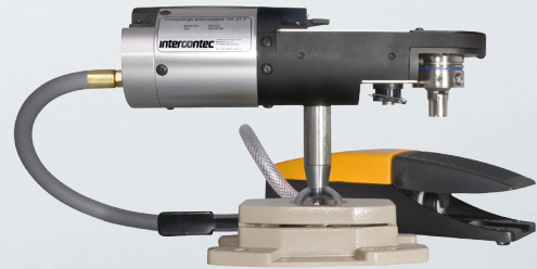
C0.217.00 Pneumatische Crimpzange Pneumatic Crimp Tool für Ø 1 mm und Ø 2 mm Kontakte bis Aderquerschnitt 4,0 mm 2 , inklusive Positionierer, Standfuß, Luftschlauch und Fußschalter for Ø 1 mm and Ø 2 mm contacts max wire gauge 4 mm 2 includes positioner, standing support, air hose and foot switch
