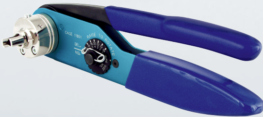
C0.201.00 Crimpzange, mittel Crimp Tool, mid-size für Ø 1 mm und Ø 2 mm Kontakte bis Aderquerschnitt 4 mm 2 , inklusive Positionierer for Ø 1 mm and Ø 2 mm contacts max wire gauge 4 mm 2 includes positioner
