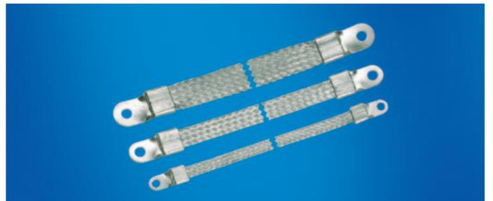
Flachbänderder, Kupfergeflecht verzinkt, in verschiedenen Längen und Querschnitten mit aufgedrückten Kontakthülsen. Flachbänderder wirken dem Stromverdrängungseffekt bei hohen Frequenzen entgegen und bieten gleichzeitig hochflexible Anschlussmöglichkeiten.
