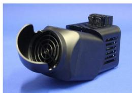
Der Lüfter ist in einem Winkel von 90° in vier unterschiedlichen Positionen auf die Hutschiene aufschnappbar. Durch ein um 40° verdrehbares Gelenk und die drehbare Luftführung an der Ausblasöffnung kann die Strömung mit 360° eingestellt werden.
